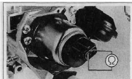
Рис. 6.18. Измерение сопротивления обмотки позиционера воздушной заслонки.
